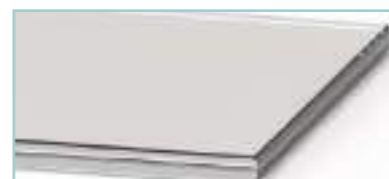
Vetro stratificato 10,76-12,76 mm classe 1B1 UNI/EN 12600 e P2A / UNI EN 356. Non possono essere forometrati
